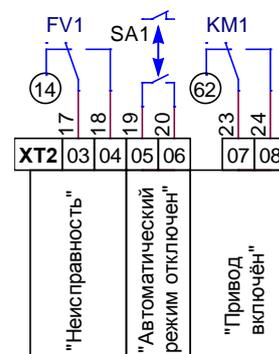
9. Для инвертирования сигнала "Автоматический режим отключён", необходимо отключить проводники 19 и 20 от нормально-открытого контакта переключателя, снять контакт с переключателя, установить на его место расположенный рядом резервный нормально-замкнутый контакт, и подключить к нему проводники 19 и 20.
